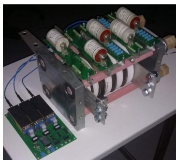
Рис. 11. Блок коммутатора БКЗТФИ2Д-100000-7,0-Е с панелью драйвера
