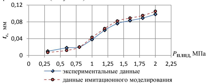
Рисунок 3 – Сравнение экспериментальных и промоделированных данных процесса пластического деформирования исследуемого титанового сплава
