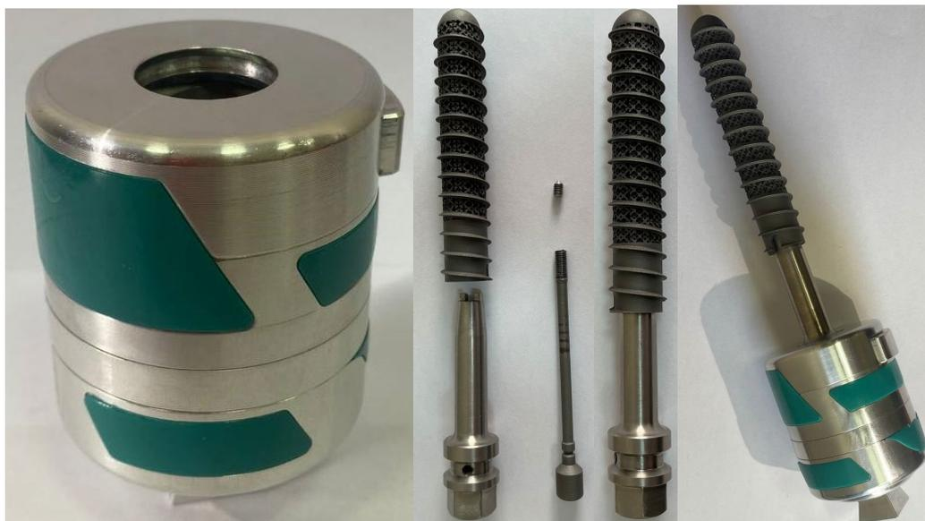
Рисунок 18 – Прототип системы интеграции протеза бедра (механическая версия)
