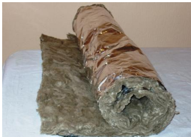
Рисунок 11 – МБОР (слева), БСТВ на фольге (справа)
