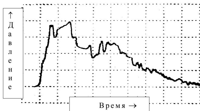
Рис. 8.2. Импульсное давление в рабочей жидкости при ЭГИ вытяжке-формовке (масштаб по времени M_t = 50 мкс/дел. и по давлению M_p = 1,2 МПа/дел.)
