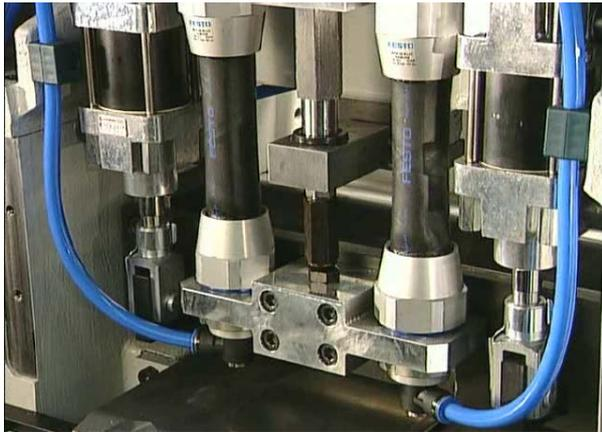
Рис. 1.3. Пневматический пресс
