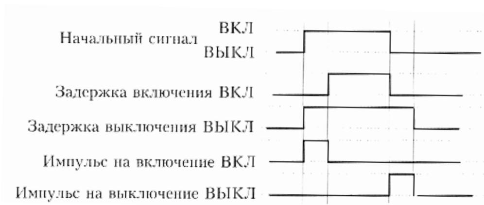
Рис. 6.4. Четыре временные функции
