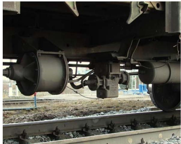
Рис. 1.6. Пневматический тормоз
