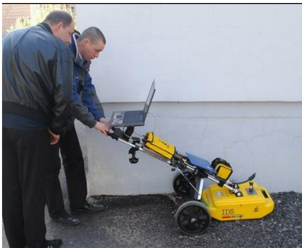
Рисунок 3.9. Исследование фундамента георадаром IDS
