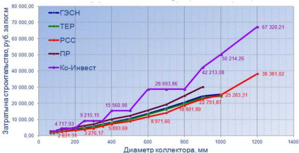
Рисунок 2.16. Сравнительный анализ показателей затрат на примере чугунных водоводов (на 01.01.2010 г.)
