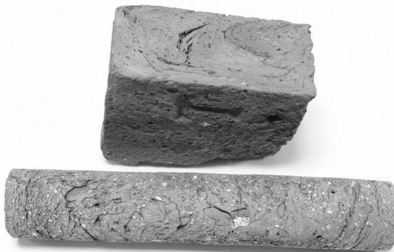
Рисунок 2.30. Слоистая структура кирпича (сверху фрагмент кирпича производства начала XX века, снизу – 1970 –х годов.)
