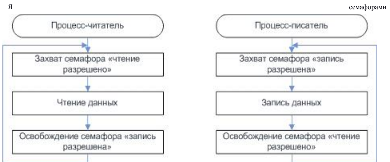
Рис.4. Организация доступа к разделяемой памяти одного «читателя» и одного «писателя»
