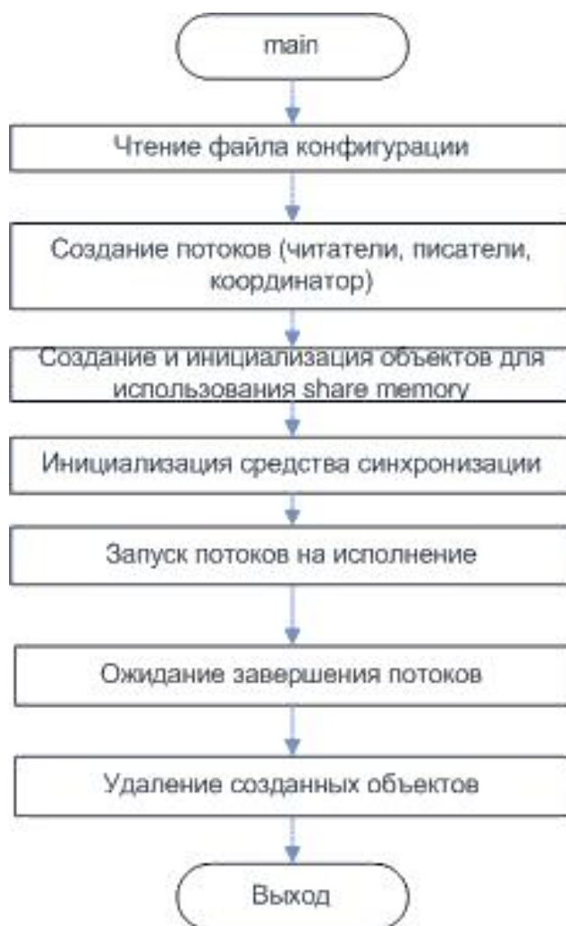
Рис. 34. Схема алгоритма работы главного потока в примере с использованием объектов-событий для синхронизации доступа к памяти потоков одного процесса
