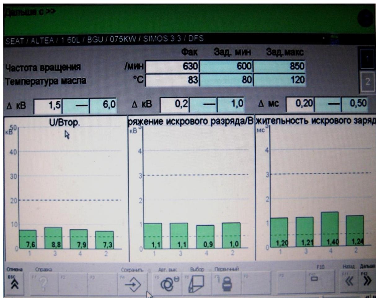
Рис. 26. Гистограммы параметров вторичной цепи зажигания
