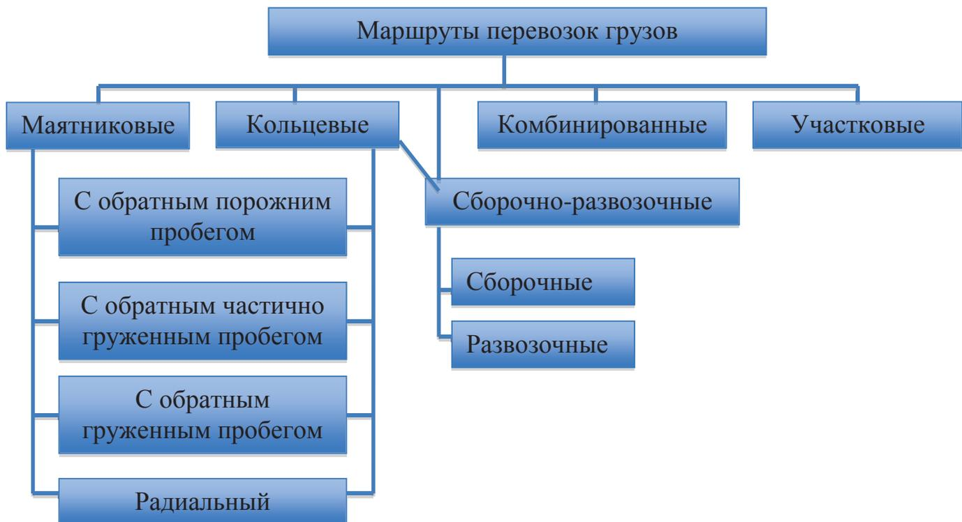
Рис. 4.4. Классификация маршрутов автомобильных перевозок
