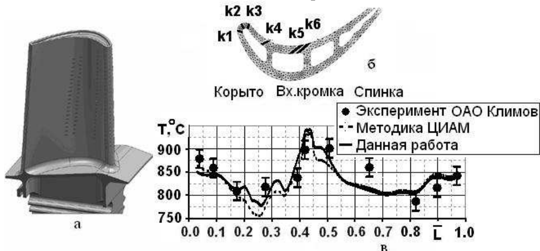
Рис. 8 Исследуемая лопатка ГТД (а); схема расположения перфораций (б); сопоставление результатов расчета с опытными данными (в)
