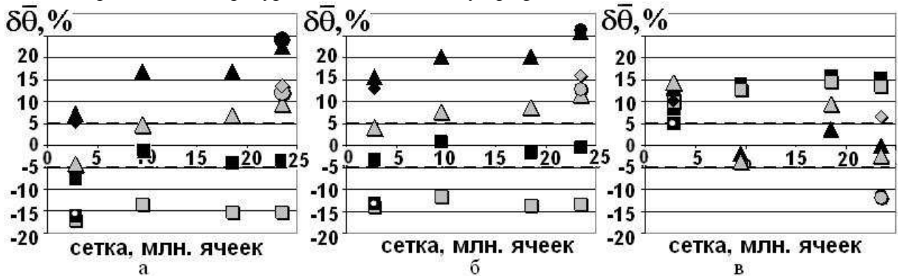
Рис. 12 Относительная погрешность расчетов по глубине охлаждения лопатки, средняя по спинке (а), средняя по корыту (б), на входной кромке (в).
