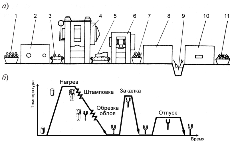
Рис. 6.1. Схема расположения оборудования облойной штамповки (а) и процесса ТМО (б): 1 — исходные заготовки; 2 — нагревательная установка; 3 — нагретые заготовки; 4 — КГШП; 5 — отштампованные поковки; 6 — обрезной пресс; 7 — поковки после обрезки облоя; 8 — печь для закалки; 9 — закалочный бак; 10 — печь для отпуска; 11 — поковки после термообработки
