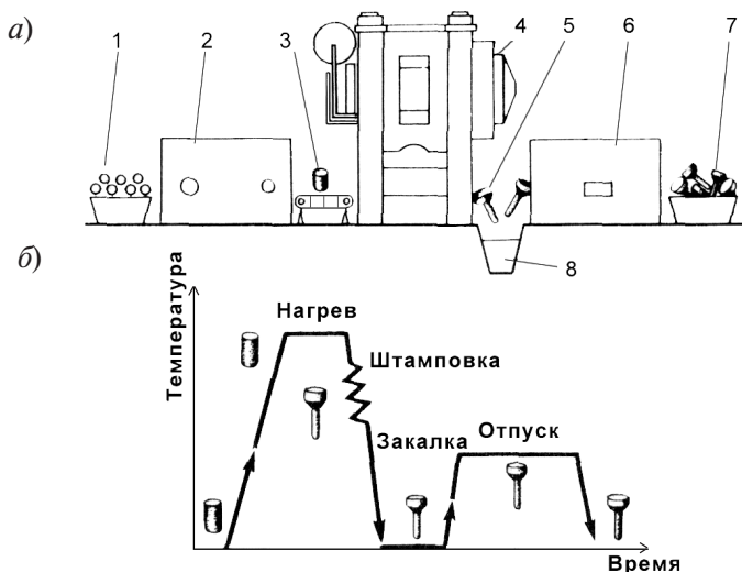
Рис. 6.4. Схема расположения оборудования штамповки выдавливанием (а) и технологическая схема процесса в режимах ТМО (б):
