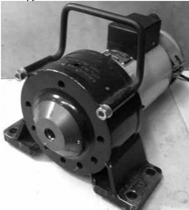
Рис. 2. Вибратор Комплекса низкочастотной вибрационной обработки ВТУ «Вепрь»
