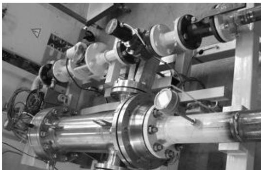
Рис.15. Установка для испытаний газодинамических подшипников
