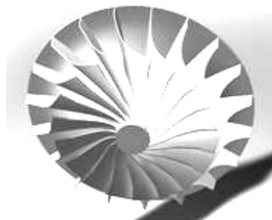
Рис.6. Рабочее колесо турбины
