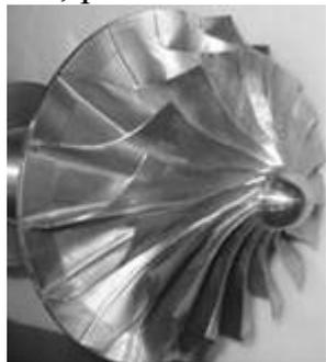
Рис.20. Фото рабочего колеса турбины
