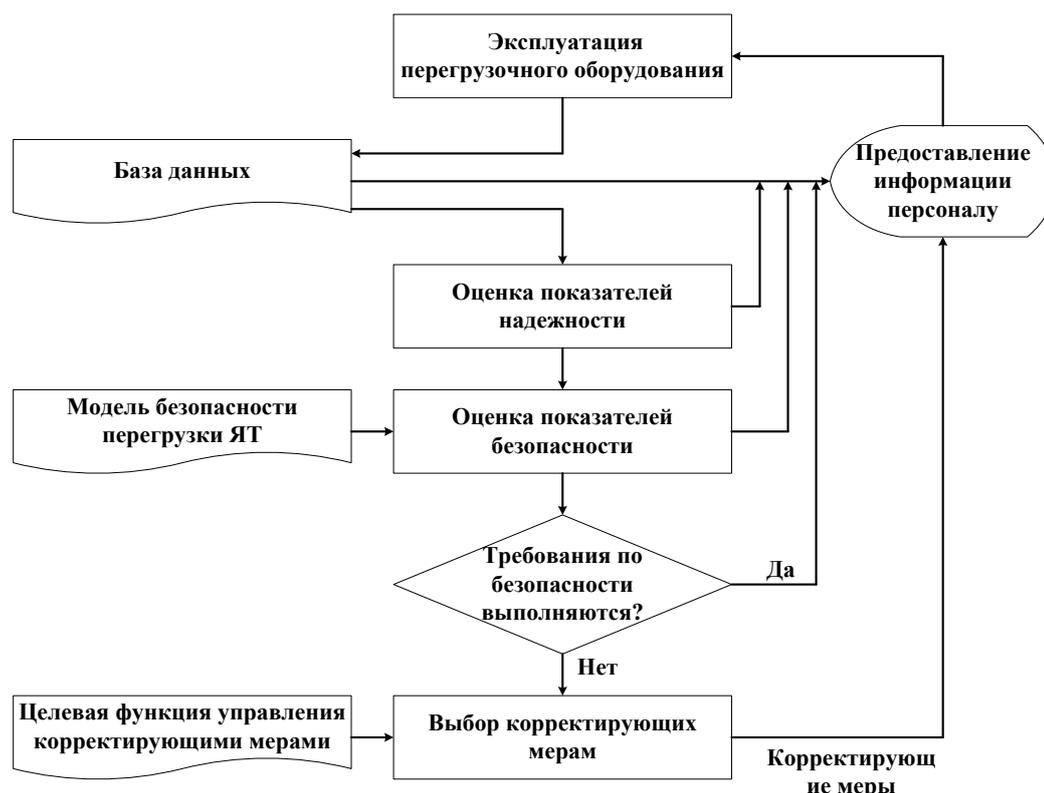
Рис. 8. Схема обеспечения безопасности перегрузки ЯТ на этапе эксплуатации перегрузочного оборудования
