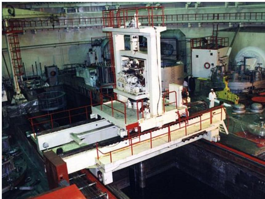
Рис. 1. Машина для перегрузки топлива
