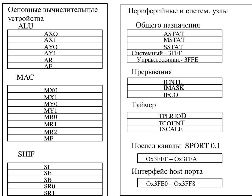
Рис.3. Программная модель процессора ADSP-2181
