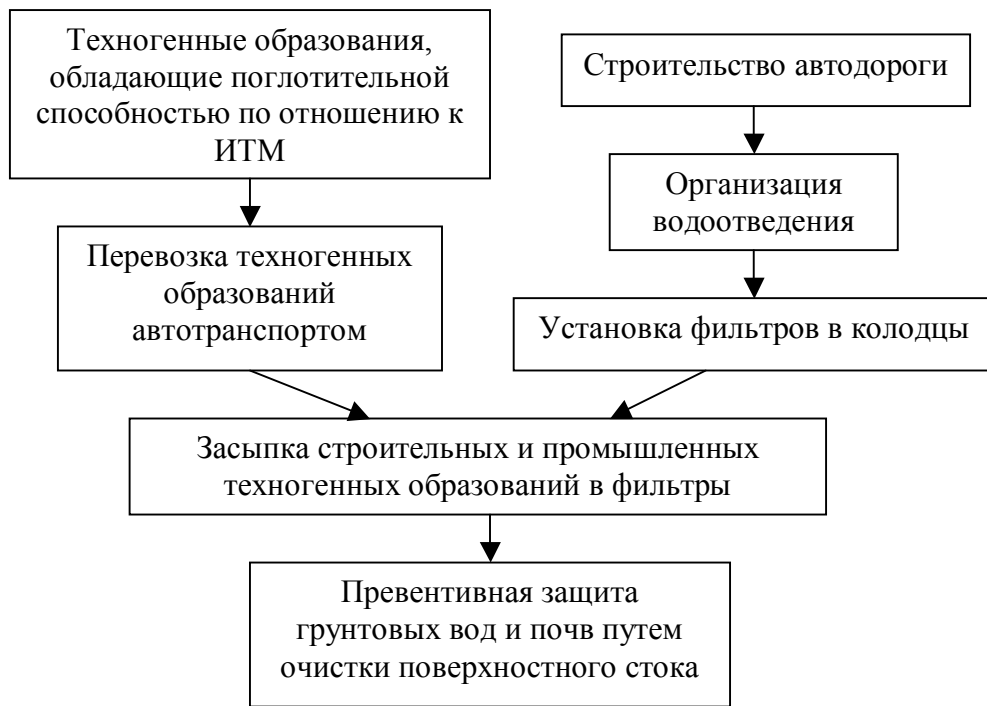
Рис. 6. Технологическая схема превентивной защиты почв и грунтовых вод с использованием техногенных образований в фильтрах
