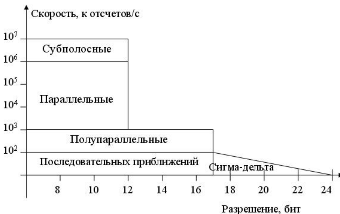
Рис. 5.1 Классификация современных АЦП по фактору точность/быстродействие
