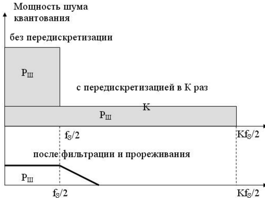
Рис. 6.3. Влияние изменения частоты дискретизации на мощность шума квантования
