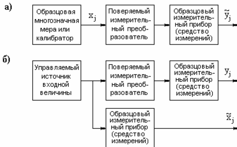
Рис. 8. Схемы поверки измерительного преобразователя методом "по мере" а) и методом "по образцовому прибору" б)
