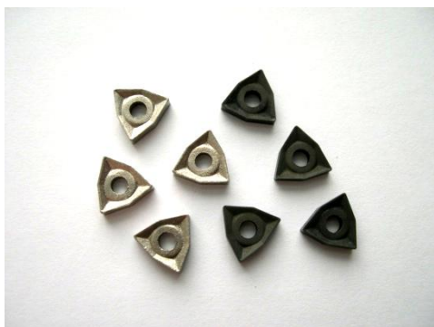
Рис.1 – Твердосплавные шестигранные пластины WNUM-080404 с Ni-Cu покрытиями (светлые) и без покрытий (темные).
