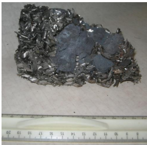
Рисунок 4 – Фотография фрагмента композитного брикета из стружки стали «Сталь 3» с добавкой кусков материала с малой электропроводностью (горной породы). Размер брикета: 200х60х60 мм; плотность 1,4 г/см 3 ; масса 1кг (400 г стружки и 600 г породы).
