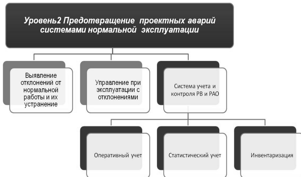
Рисунок 4 Схема компонент второго уровня защиты
