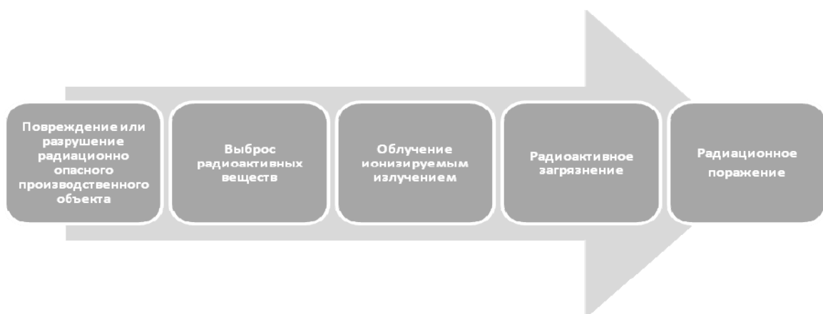
Рисунок 11 Типовой сценарий возникновения техногенной чрезвычайной ситуации при повреждении или разрушении радиационно опасного производственного элемента
