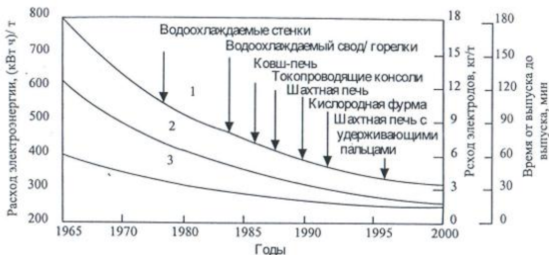
Рис. 1.1. Развитие электросталеплавильного производства с использованием разработок фирмы «Fuchs»:
