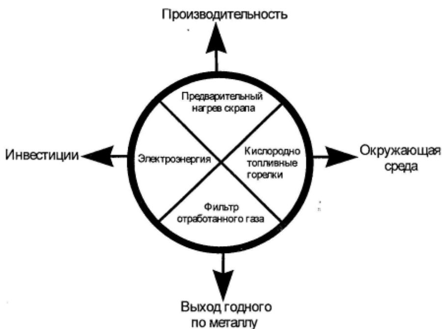
Рис. 1.5. Основные преимущества шахтной печи с поддерживающими «пальцами»
