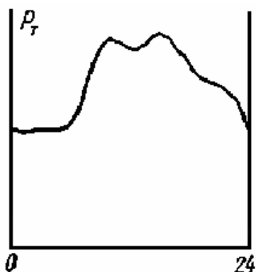
Рис. 2.7. Суммарный график технологической нагрузки промышленного района
