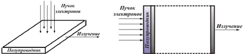
Рис. 5.8. Поперечная и продольная накачка электронным пучком.
