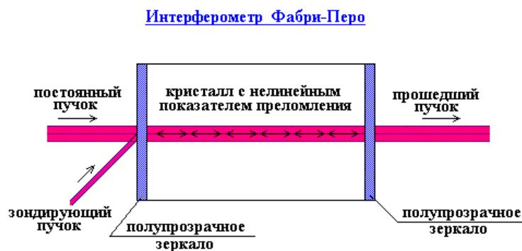
Рис. 1.4. Структурная схема трансфазора.
