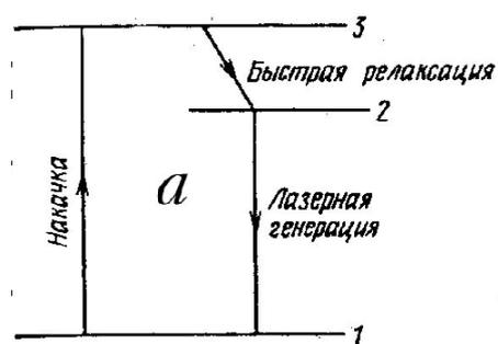
достаточно долго без спонтанного испускания фотонов (такой уровень называется метастабильным). И только под воздействием проходящей электромагнитной волны атом возвращается на основной уровень  $E_1$ , испуская вынужденное излучение частотой  $\nu=(E_2 - E_1)/h$ , когерентное исходной волне.
