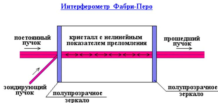
Рис. 1.4. Структурная схема трансфазора.
