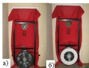
Рисунок 4. Помещение, расположенное на первом этаже а) с повышением давления; б) с понижением давления.
