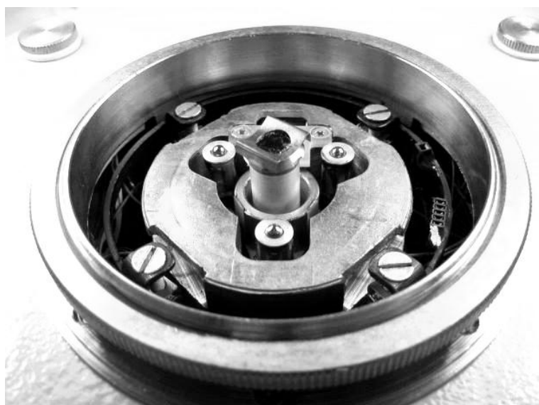
Рис. 51. Образец, установленный на сканер без СТМ-столика
