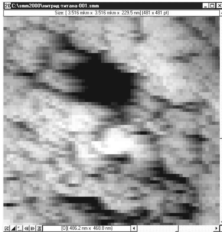
Рис. 42. Увеличенная пора из кадра на рис. 41 без интерполяции
