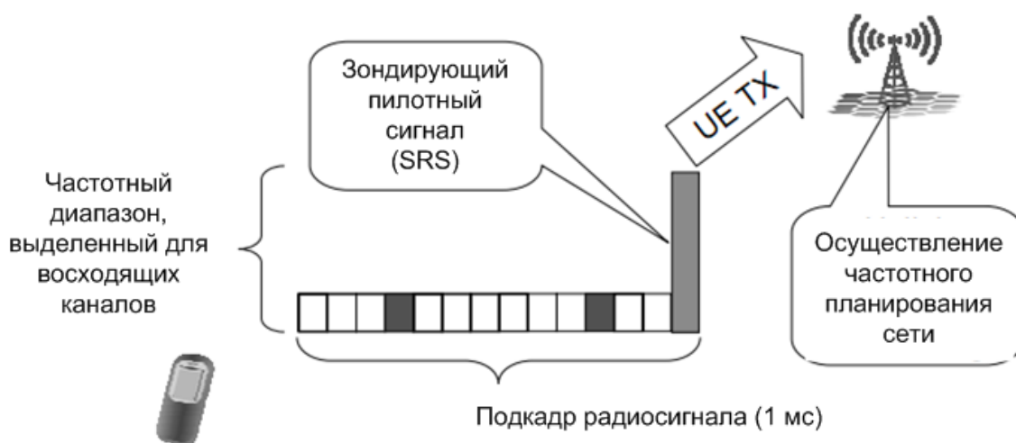
Рис. 2.34. Передача зондирующего пилотного сигнала
