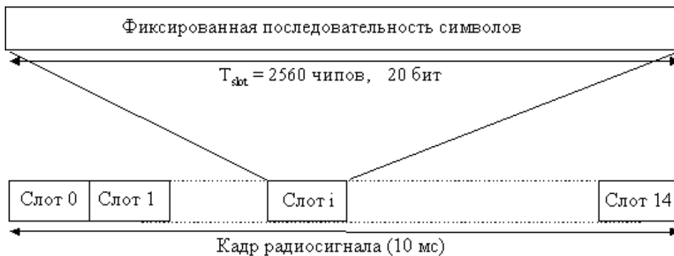
Рис. 3.18. Структура слота канала CPICH
