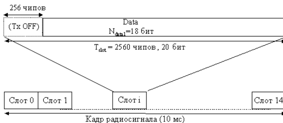
Рис. 3.19. Структура слота канала P-ССРСН
