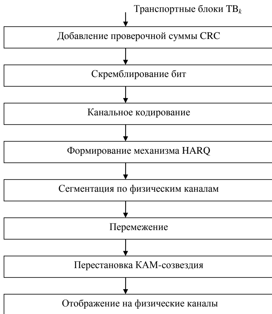
Рис. 2.10. Схема формирования канала CСТrС для транспортного канала HS-DSSS
