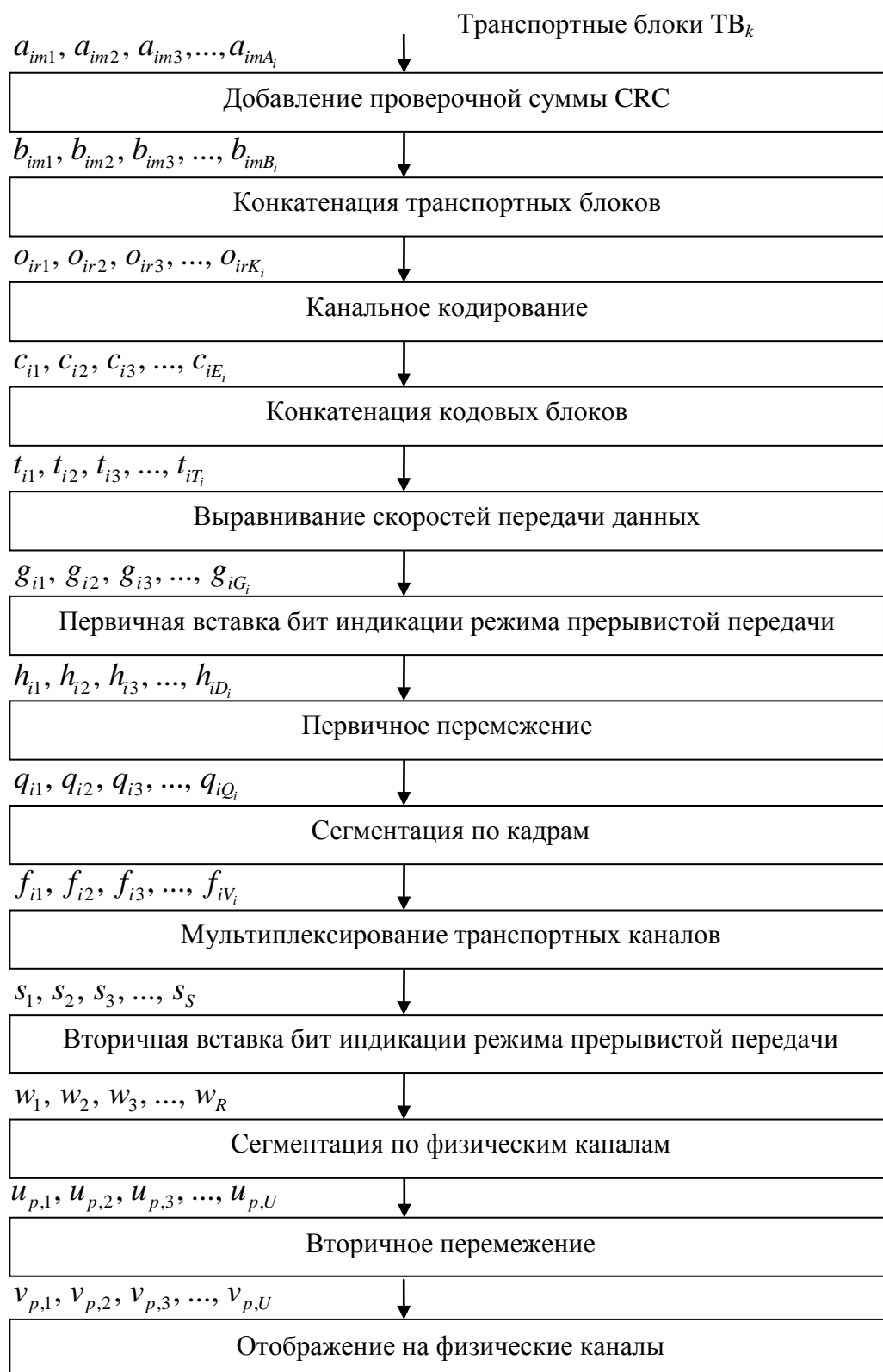
Рис. 3.1. Схема формирования кодированного композитного транспортного канала ССТrС для нисходящих каналов DСН, ВСН, FACH, РСН
