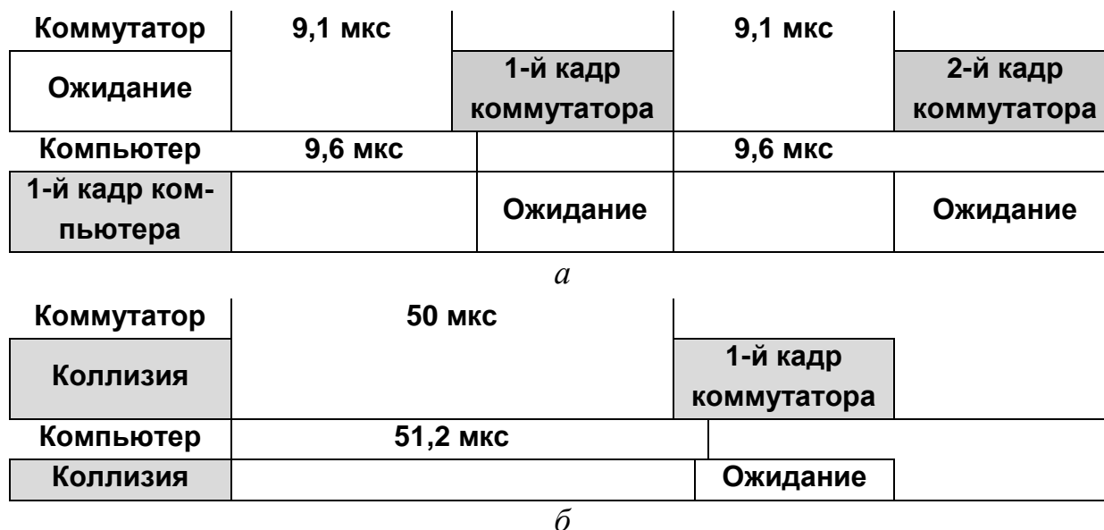
Рис. 3.20. Агрессивное поведение коммутатора при перегрузках буферов
