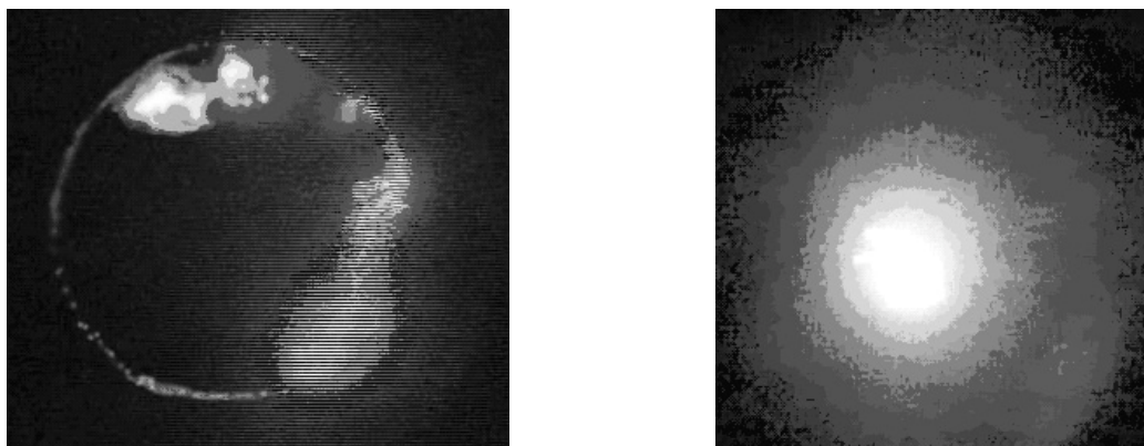
Рис. 3.23. Типы вакуумно-дуговых разрядов: а – с интегрально-холодным катодом (катодные пятна перемещаются по рабочей поверхности); б – с горячим катодом (разряд распределен по всей поверхности)
