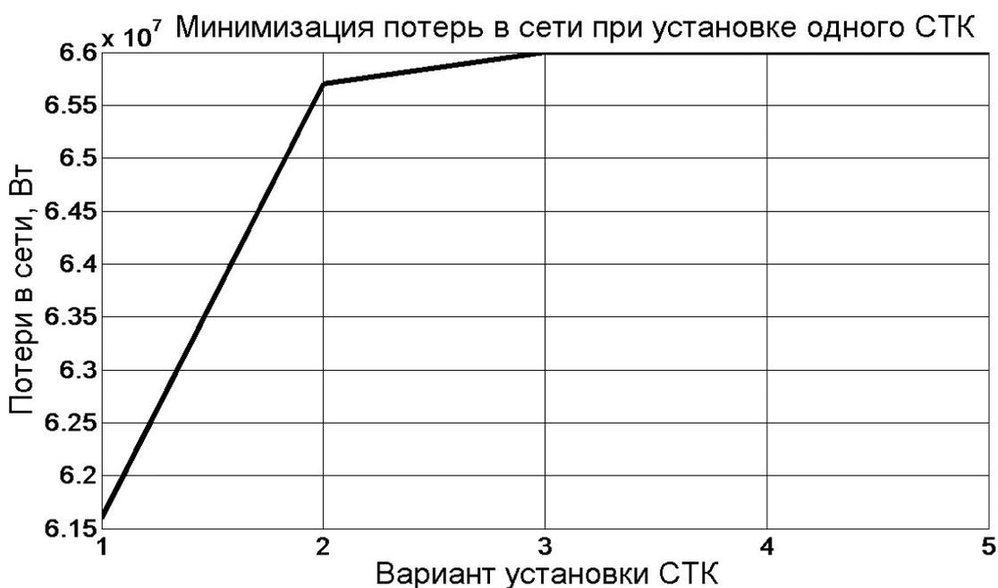
Рис. 3.48. Зависимость минимальных потерь от места установки СТК
