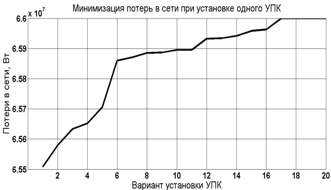
Рис. 3.47. Зависимость минимальных потерь от места установки УПК
