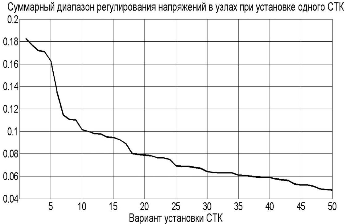
Рис. 3.52. Зависимость наибольшей ширины диапазона варьирования напряжений при установке СТК (в о.е. соответствии с (3.45))
