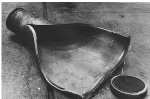
Труба 4 327×27 мм, сталь 08X18Н10Т: разрушение при внутреннем давлении 52,8 МПа
