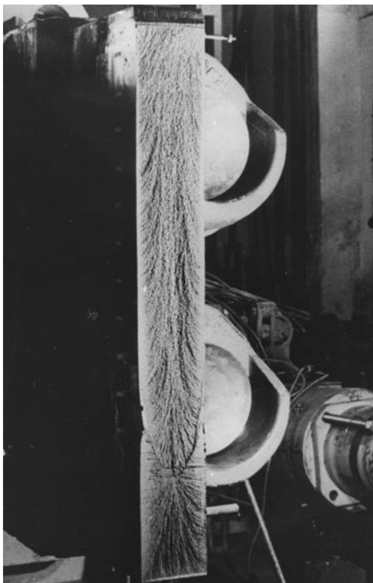
Рис. 5.3. Вид излома модели после испытаний
