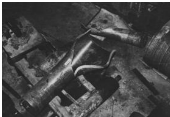
Труба 1 358×39 мм, сталь 10ГН2МФА: разрушение при внутреннем давлении 99,1 МПа
