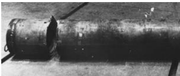
Труба 5 327×27 мм, сталь 08Х18Н10Т: разрушение при внутреннем давлении 51,5 МПа
