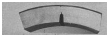
Рис. 5.10. Внешний вид труб, разрушенных газом
