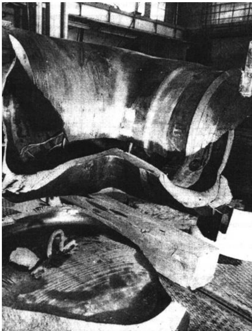
Рис. 5.19. Пример испытаний до разрушения коллектора реактора РБМК–1000
