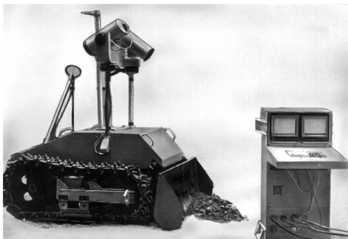
Рис.29. Тяжелый робот ТР-Г2 с бульдозерным ножом (справа пульт управления).
