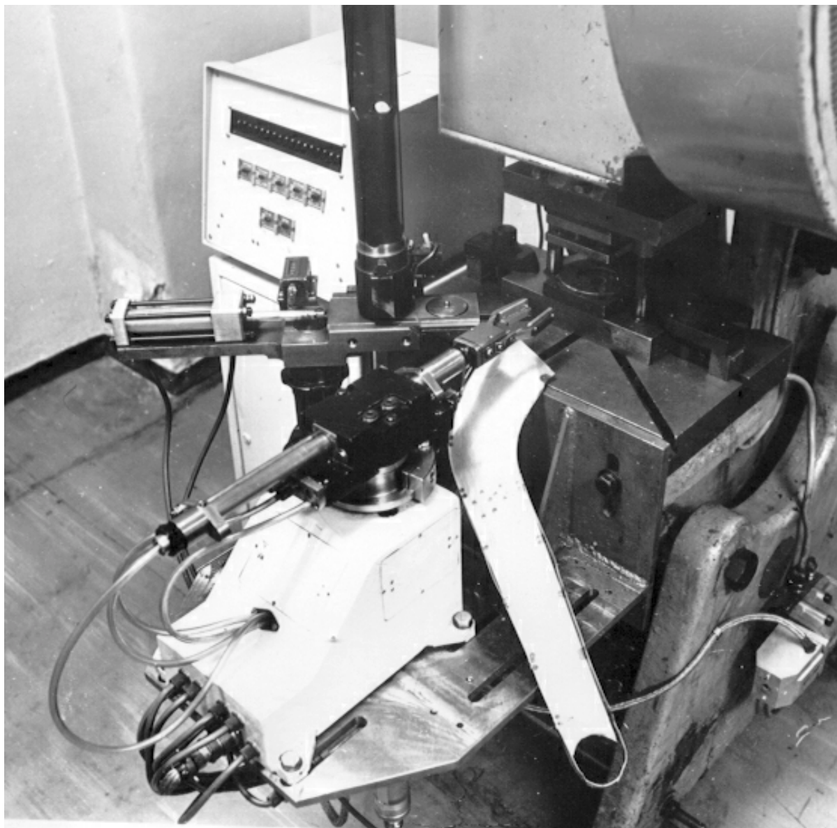
Рис.34. Робот МП-9С на обслуживании прессы холодной штамповки. Справа устройство группового управления и магазин заготовок (вертикальный) с пневматическим толкателем. Слева – лоток для сбрасывания деталей в магазин.
