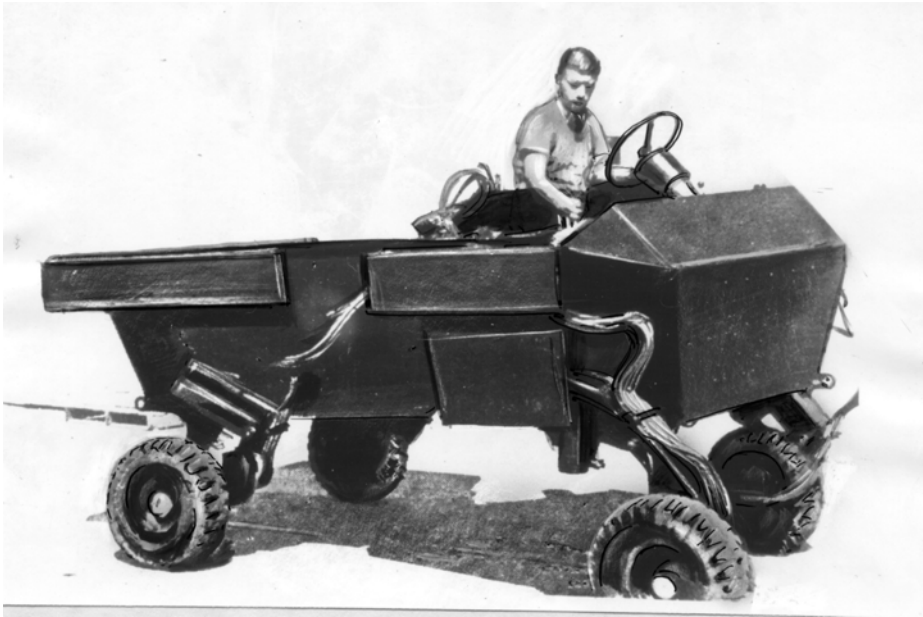
Рис.3.23. Образец колесно-шагающей машины с четырьмя колесами.
