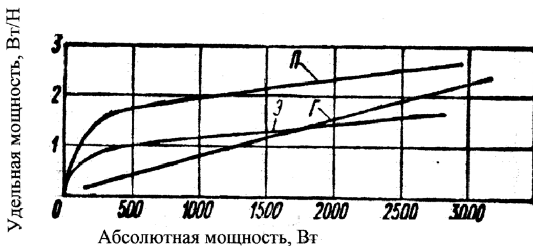
Рис.4.2. Удельная мощность электрических Э, гидравлических Г и пневматических П приводов в зависимости от их абсолютной мощности.
