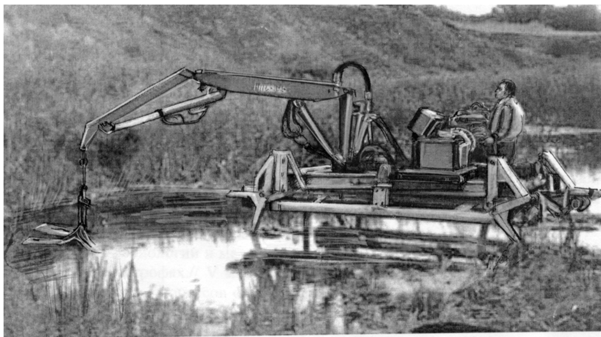
Рис.3.21. Мобильный четырехногий шагающий робот для сбора разлитых нефтепродуктов. (Волгоградский ГТУ).
