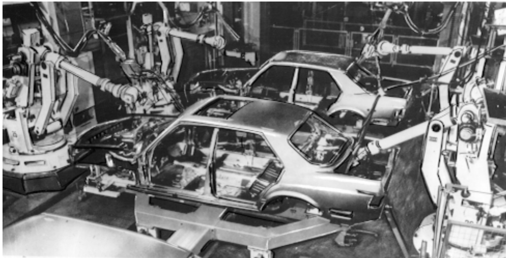
Рис.9.8. Участок точечной сварки роботами кузовов автомобилей.
