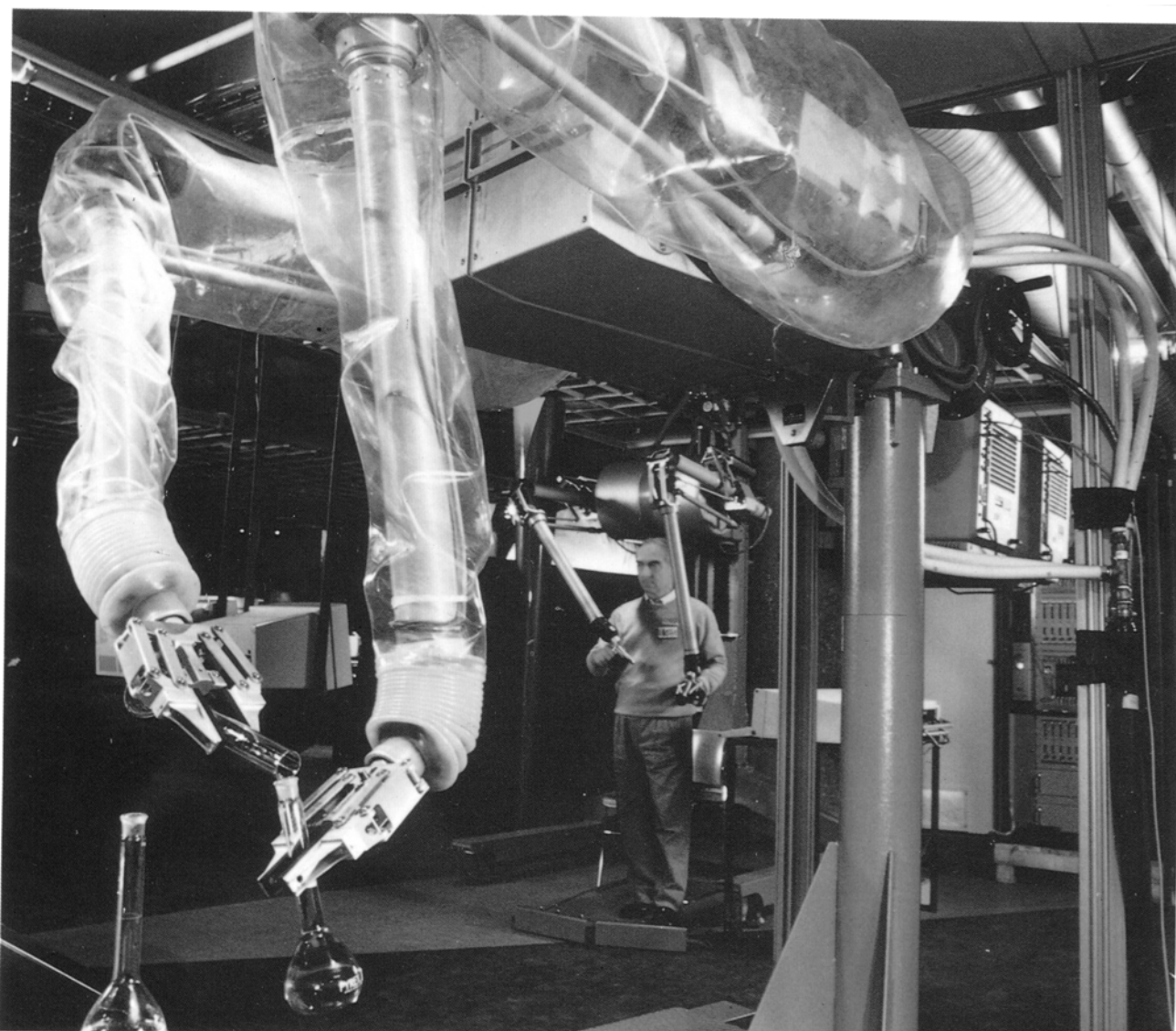
Рис.1.4. Копирующий манипулятор Маскот фирмы «Телеробот» (Италия).
