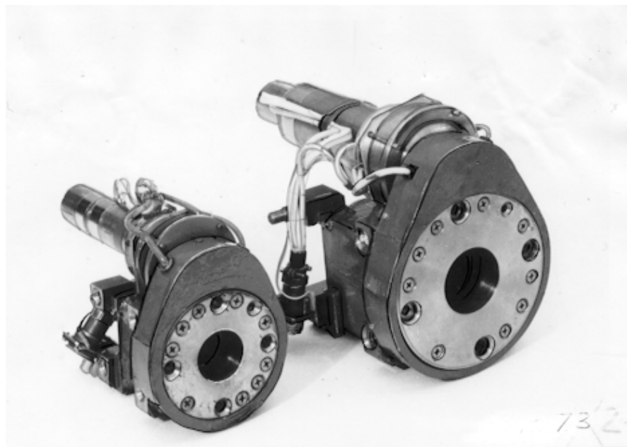
Рис.7.2. Электромеханические вращательные модули-приводы типа ПРЭМ.
