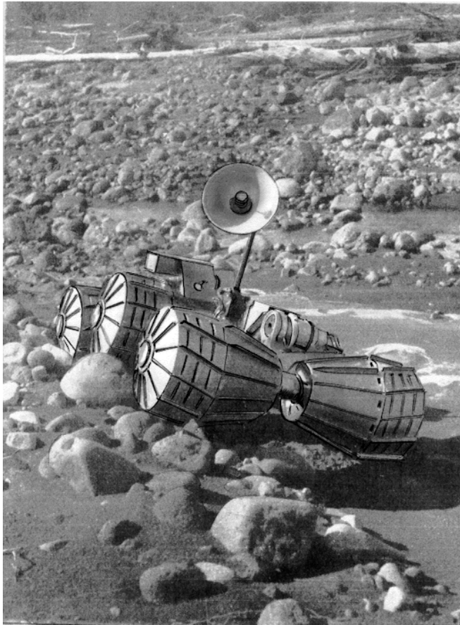
Рис.3.30. Экспериментальный образец аппарата «Марсоход» на испытаниях.
