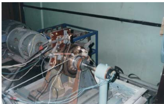
Рис.5. Лабораторная установка для исследования характеристик принципиально новых высоковольтных и низковольтных контактных пар.
