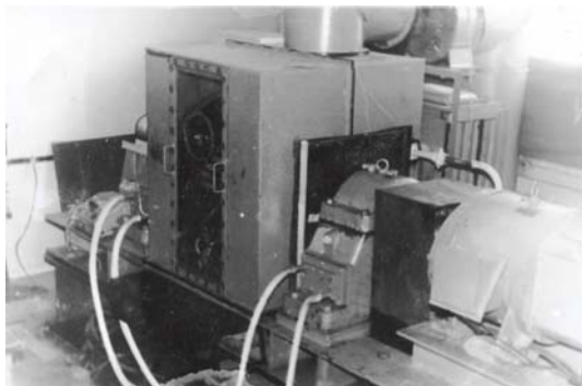
Рис.3. Общий вид автоматизированного электротехнического комплекса (АЭК) для исследования характеристик систем токо-съемы турбогенераторов большой мощности в различных газовых средах.
