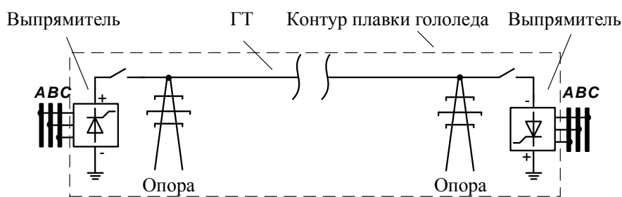
Рисунок 1 – Схема плавки гололеда «ГТ-земля»
