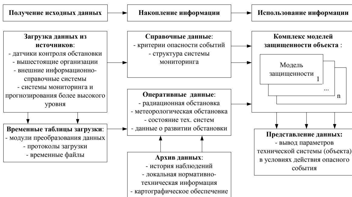
Рисунок 6 - Схема информационного взаимодействия разрабатываемой системы мониторинга
