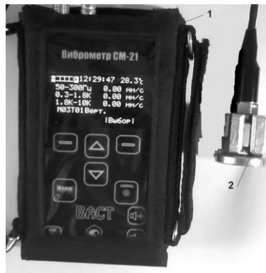
Рисунок 4 Виброметр SM-21: 1– прибор с информационным табло; 2 – акселерометр с магнитным держателем
