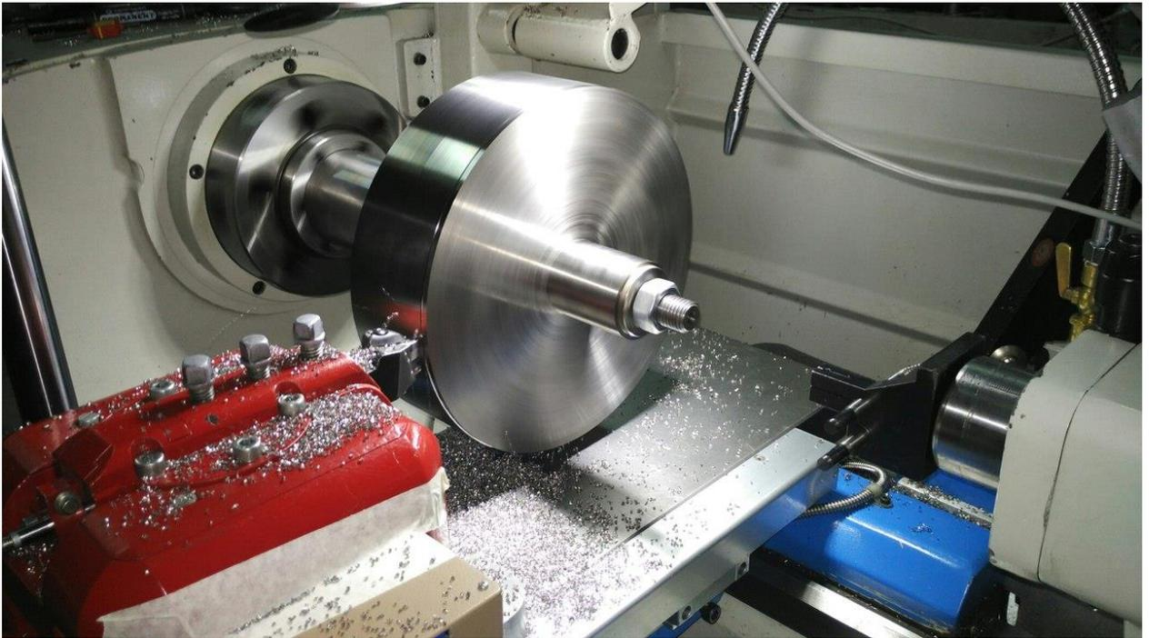
Рисунок 10 – Обработка детали типа «Диск» из материала ВТ41 на многопараметрическом стенде
