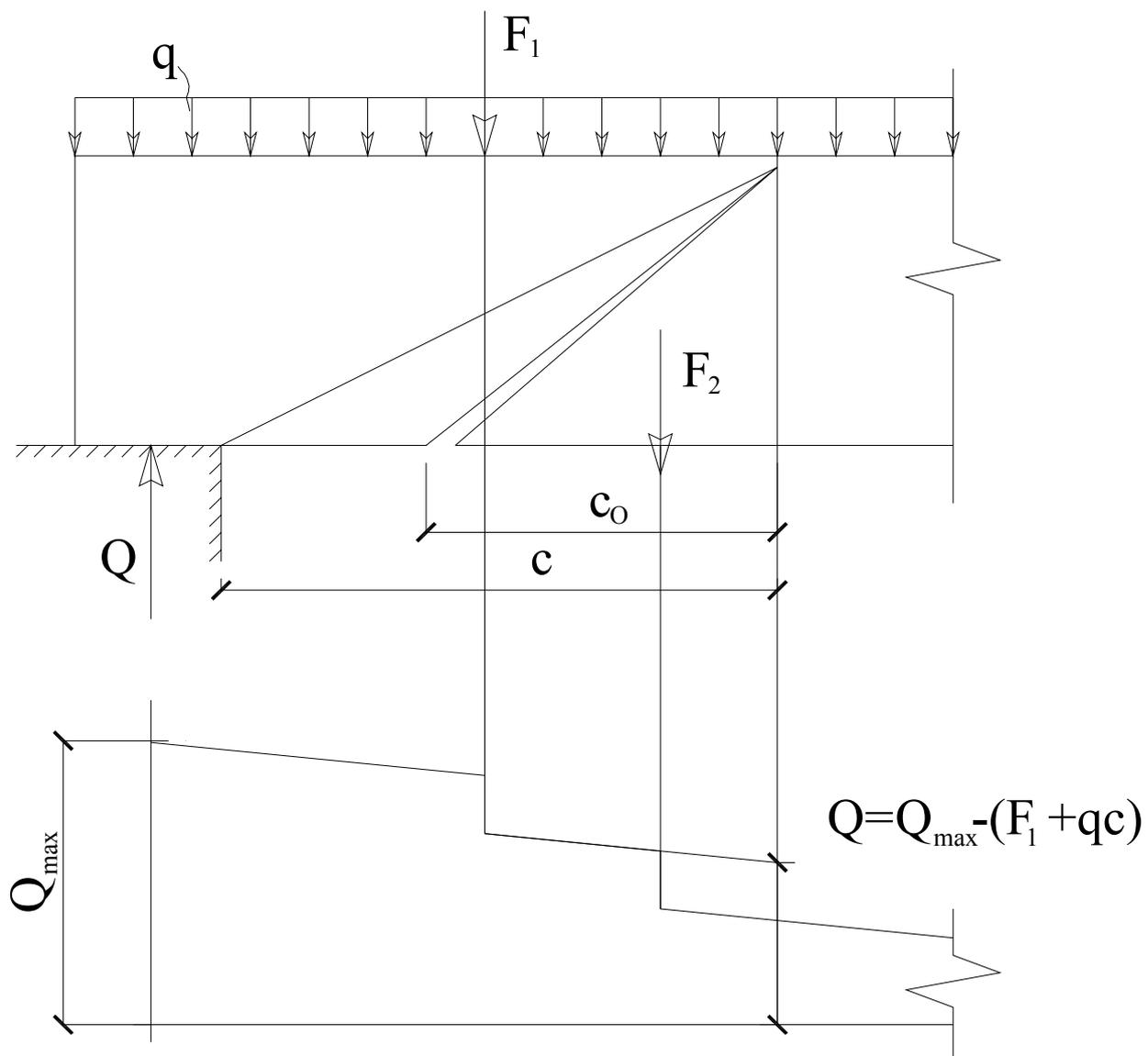
Рис. 1. К определению расчетной поперечной силы
