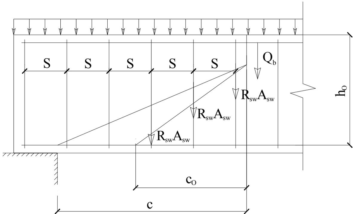
Рис. 2. Усилия, действующие на блок элемента, отделенный сечением, проходящим через наклонную трещину
