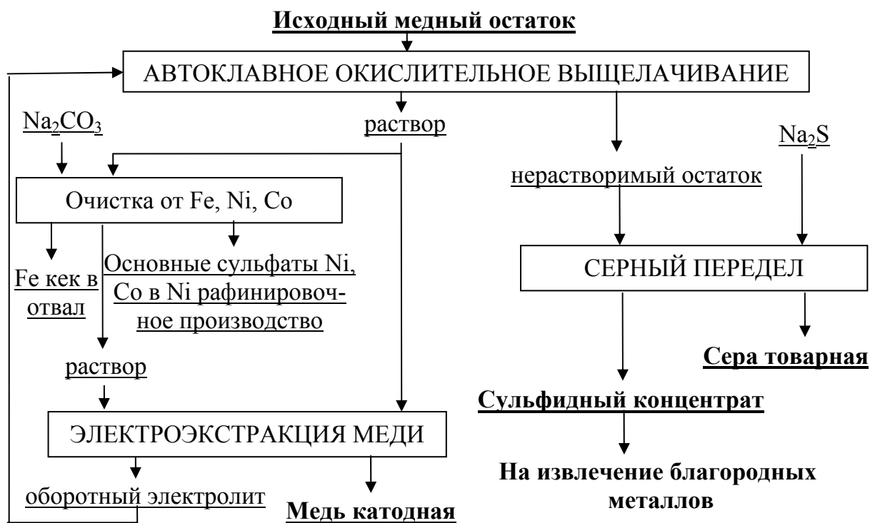
Рисунок 9 - Автоклавно - гидрOMETаллургическая технология переработки медного остатка от выщелачивания медно-никелевого файнштейна
