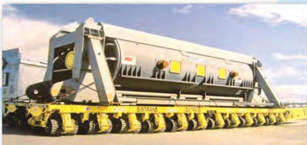
**Рис. 6. Самоходные кильблоки: грузоподъемность – 400 т; размеры – 2,36×7,5×1,86 м; колея тележки – 1 м; максимальная скорость – 3–5 м/мин.**
