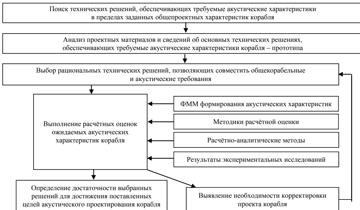
Рис. 1. Структура методов акустического проектирования корабля
