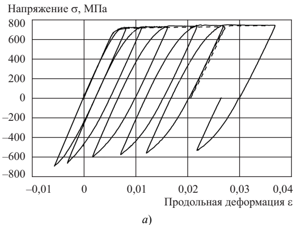
Рис. 10. Экспериментальное исследование эффекта Баушингера методом зондирования:
