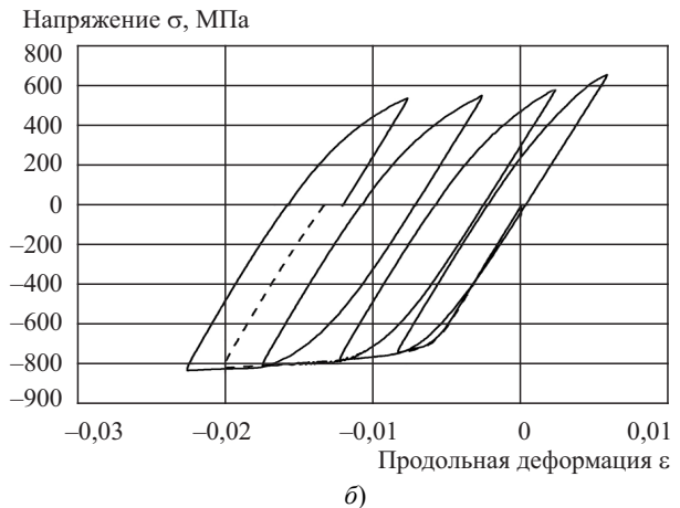
Рис. 10. Экспериментальное исследование эффекта Баушингера методом зондирования:
