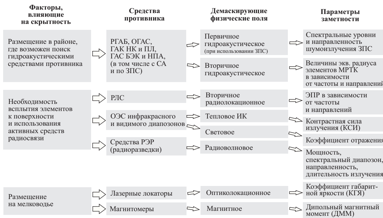
Рис. 3. Влияние основных особенностей применения позиционных морских робототехнических комплексов на необходимость нормирования различных параметров их заметности
