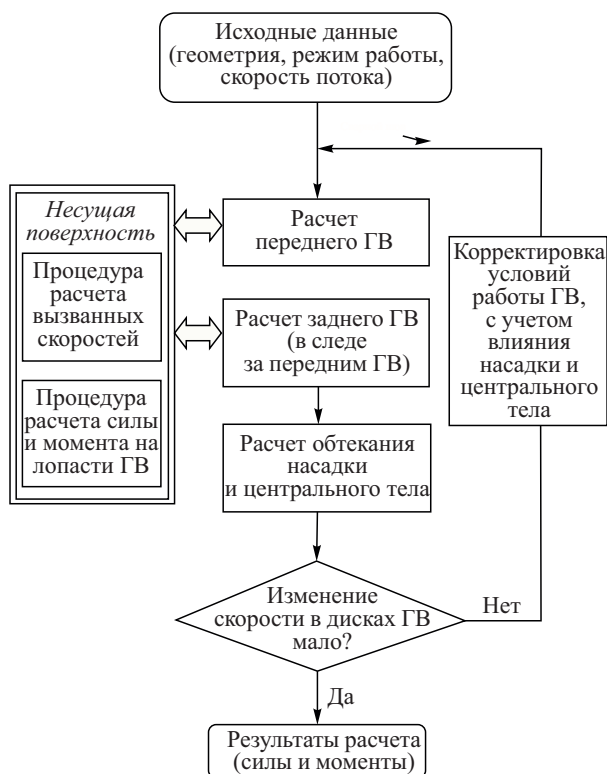
Рис. 2. Схема расчета тандемного движителя
