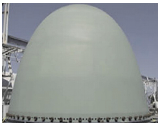
Рис. 1. Обтекатель подлодки перед монтажом
