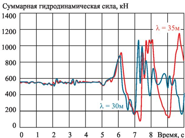
**Рис. 8.** Изменение суммарной гидродинамической силы в процессе взаимодействия деформируемых корпусов катамарана
